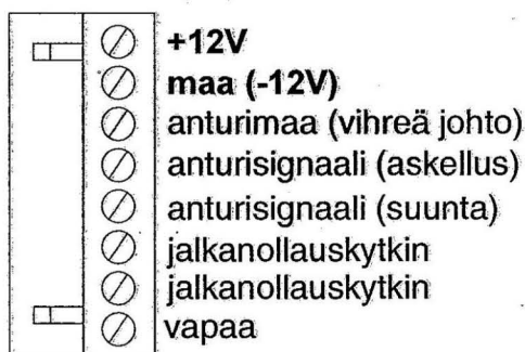
Laskimen takana olevan liittimen johdinjärjestys
